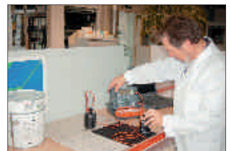
Auf einer Testfläche werden im Labor die Spannungswerte der beschichteten Flächen geprüft
