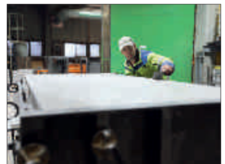
Der Finish am fertig gegossenen Element muss schnellgehen. Die Abbindezeit von Polymerbeton ist kurz.
