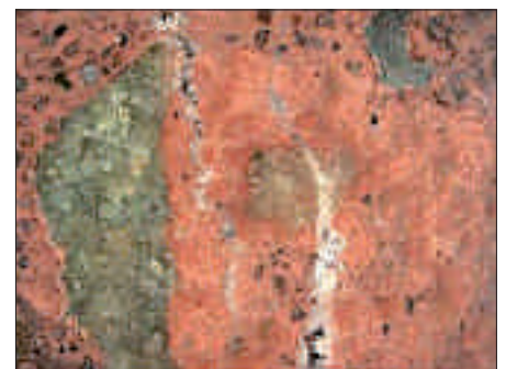
BETOCRETE-C17 (BV) in eingefärbtem Beton nach 21 Tagen Wasserlagerung
