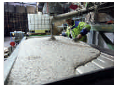
Kontinuierlich läuft der Brei über den Wärmetauscher. Innert weniger Minuten wird er überdeckt und die Form gefüllt sein.
