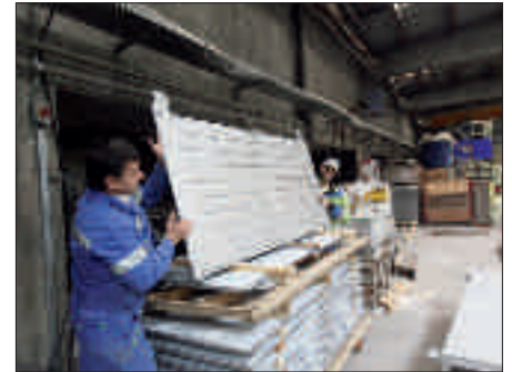
Behutsam wird das sehr dünne Wärmetauscherelement vom Stapel genommen.
